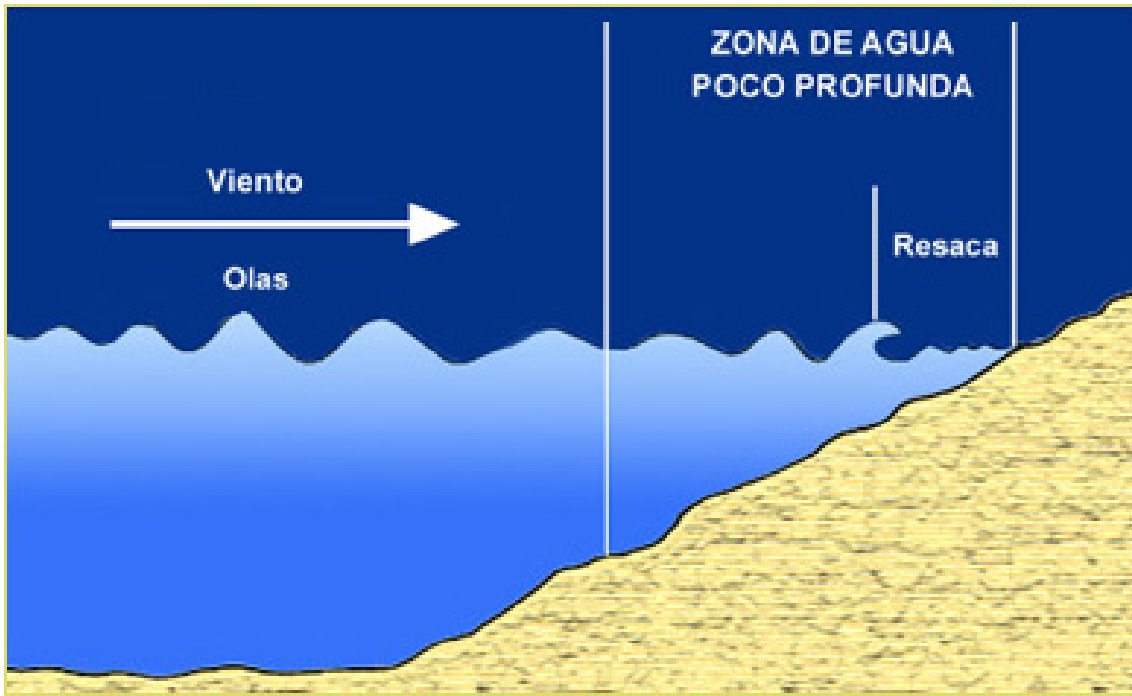
Figura 1. 9. Rotura del oleaje (imagen de Internet)
