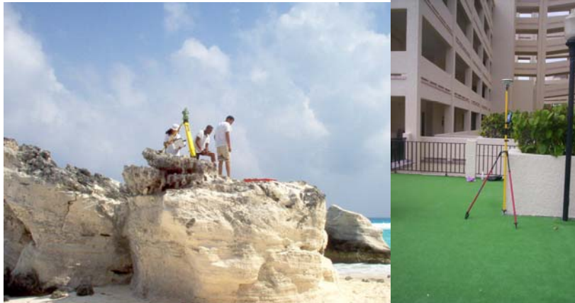
Figura 2. 6. Utilización de la estación total y GPS
