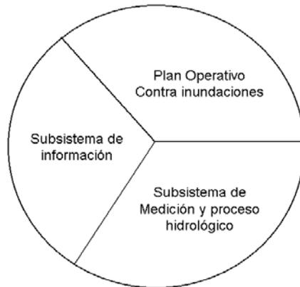
**Figura 1.1 Componentes indispensables de un Sistema de Alerta Hidrometeorológica**
