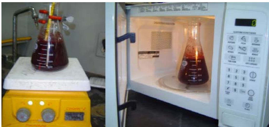
Figura 16. Método tradicional de calentamiento y método verde con microondas, de izquierda a derecha respectivamente.
