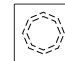
D-1 CILINDRO DE CONCRETO ARMADO F'c=205 kg/cm 2 70 CM DE DIAMETRO Y 20' 00 CM DE PERALTE SEGUN NORMAS DEL R.C.D.F.
