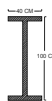
T-1 VIGA DE ACERO ALTA RESISTENCIA 40 (100 CM DE ALMA Y PATIN DE 10' 40 CM) HECHA CON PLACA DE 2" SOLDADA CON ELECTRODO SEGUN PROYECTO ESTRUCTURAL.
