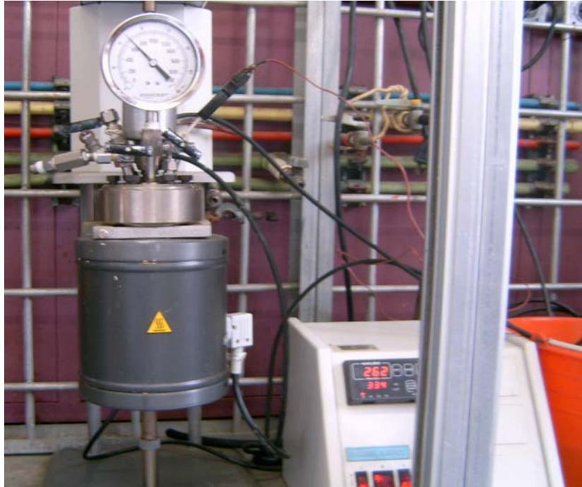
Figura 2.1. Reactor marca PARR con su instrumentación completa.
