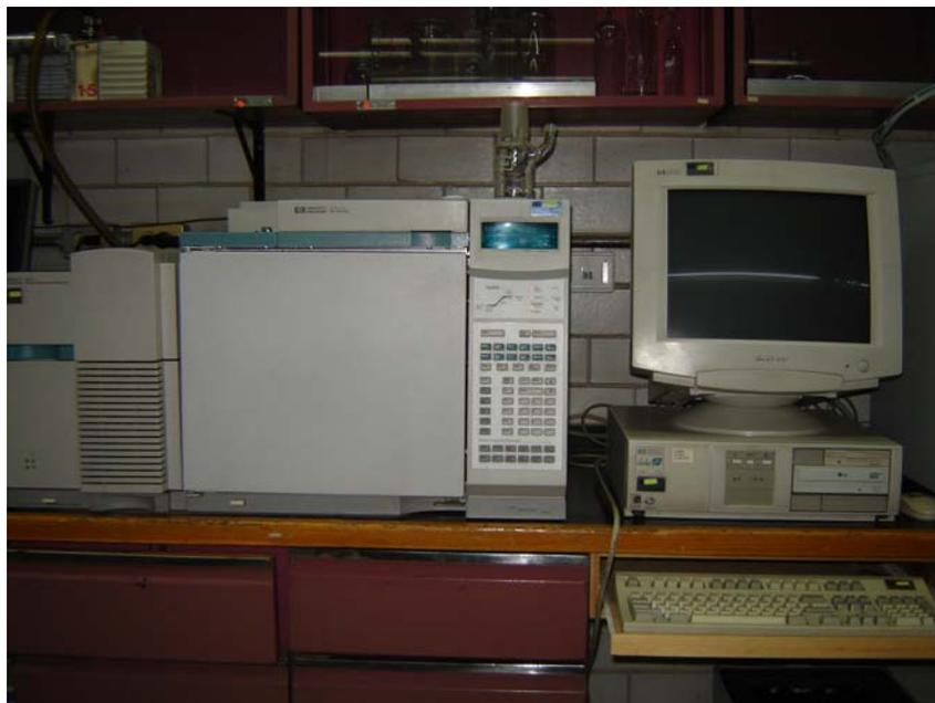
Figura 2.4. Cromatógrafo de gases marca HEWLETT PACKARD 6890 GC System.
