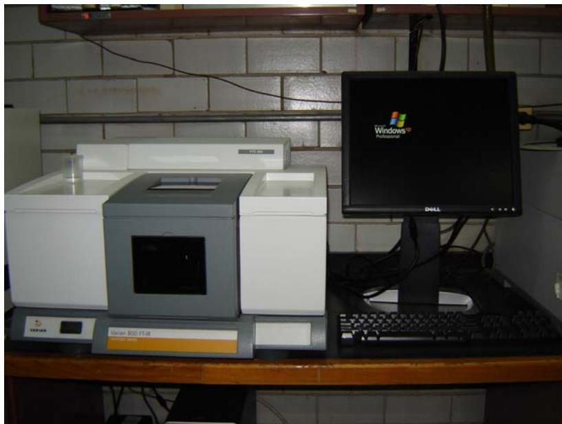
Figura 2.3. Espectrofotómetro de infrarrojo marca VARIAN 800 FT-IR.
