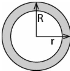
e) Encuentra un modelo algebraico para la cantidad de concreto que se necesita para hacer una tubería que tiene  $l$  metros de largo, un radio exterior  $R$  y un radio interior  $r$  ( como en la figura de abajo) . En particular, si  $l = 500$  m ,  $R = 70$  cm y  $r = 60$  cm, ¿qué volumen de concreto se requiere?.
