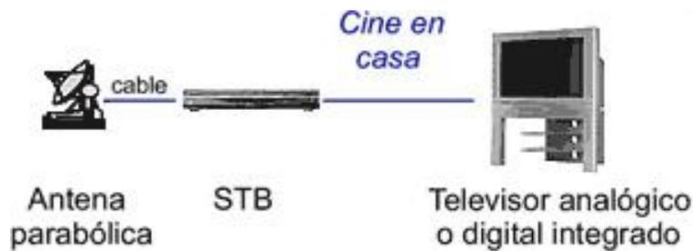
Figura 1.5 Configuración de la Recepción de Televisión Vía Satélite.
