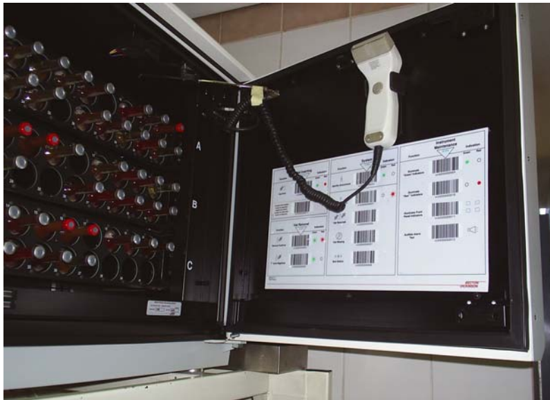
Foto 8: Incubación de hemocultivos A) Incubación a 37°C. B) Incubación en equipo BACTEC™ 9120
