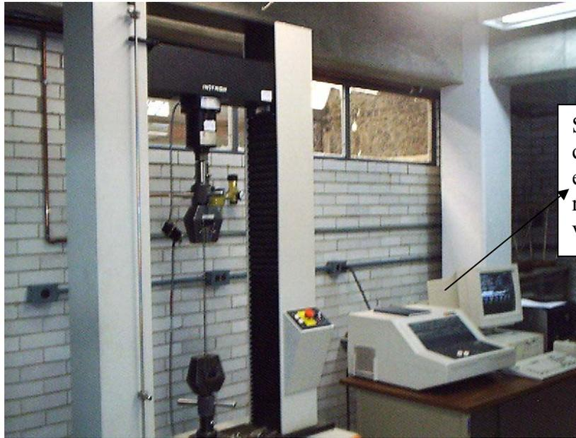
Software para calcular los esfuerzos y resistencia de las varillas.
