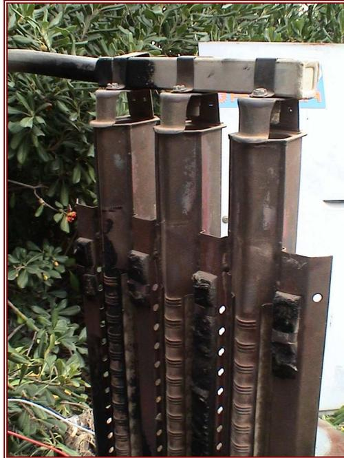
**Figura 6.9. Arreglo del quemador de flama corta.**
