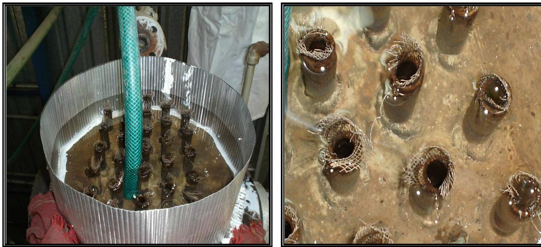
**Figura 7.2.6 (a) y (b). Vista de la parte superior del absorbedor después de quitarle la tapa y llenarlo con agua para inspeccionar el mojado de los tubos.**
