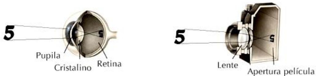
(a) Formación de la imagen en el ojo humano (b) Formación de la imagen en una cámara Figura 1.2.
