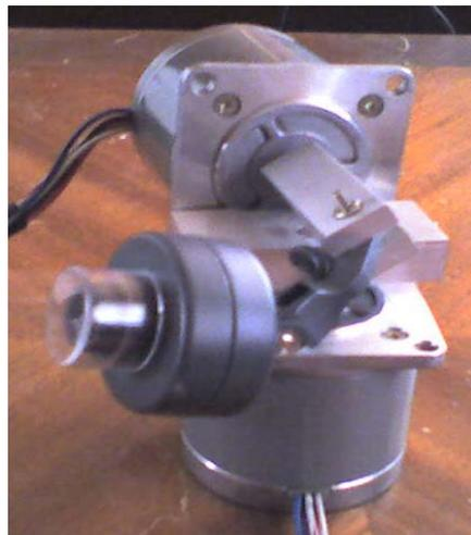
Figura 3.41. Imagen de la cámara montada sobre los motores de paso.
