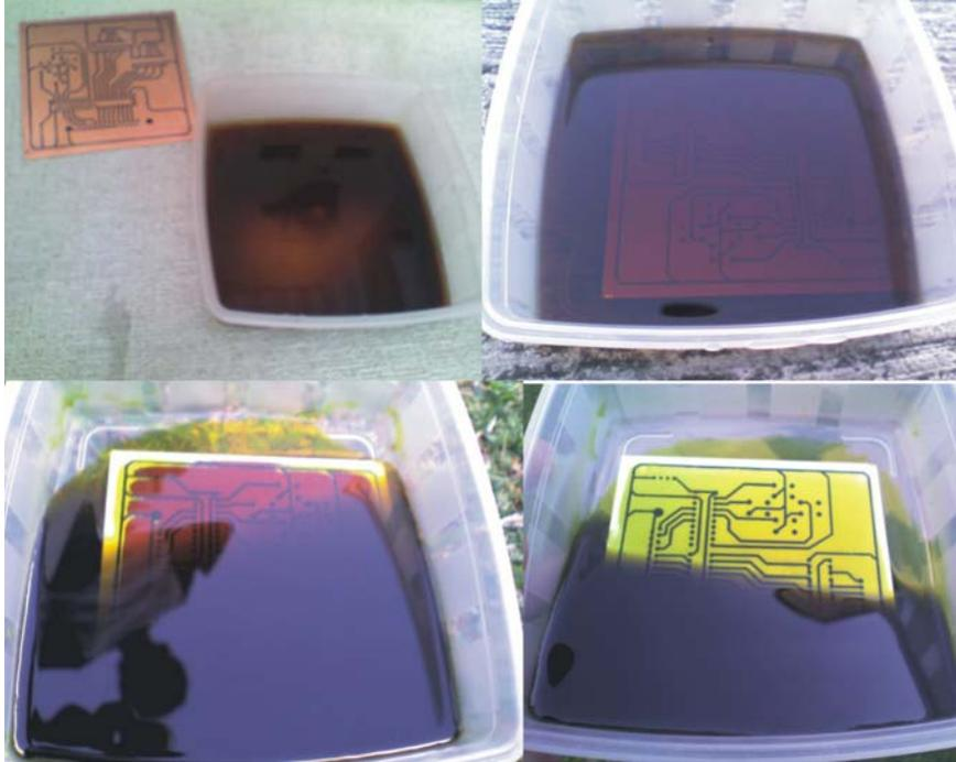
**Figura3.37.** Proceso de ataque químico del cobre.
