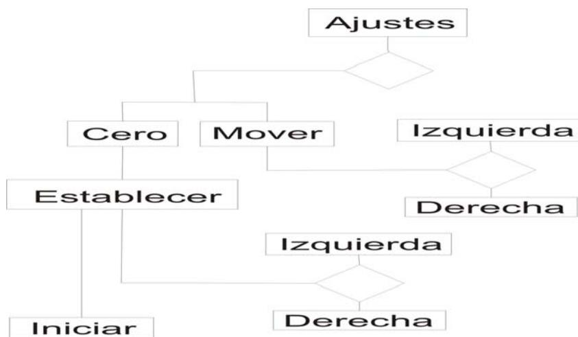
Figura 3.21. Diagrama de flujo 2 del software.
