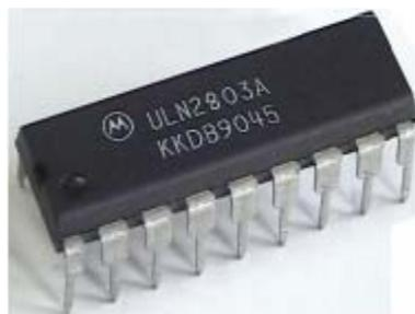
Figura 3.13. Imagen del circuito integrado ULN2803.
