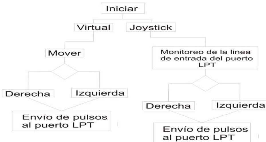
Figura 3.20. Diagrama de flujo 1 del software.
