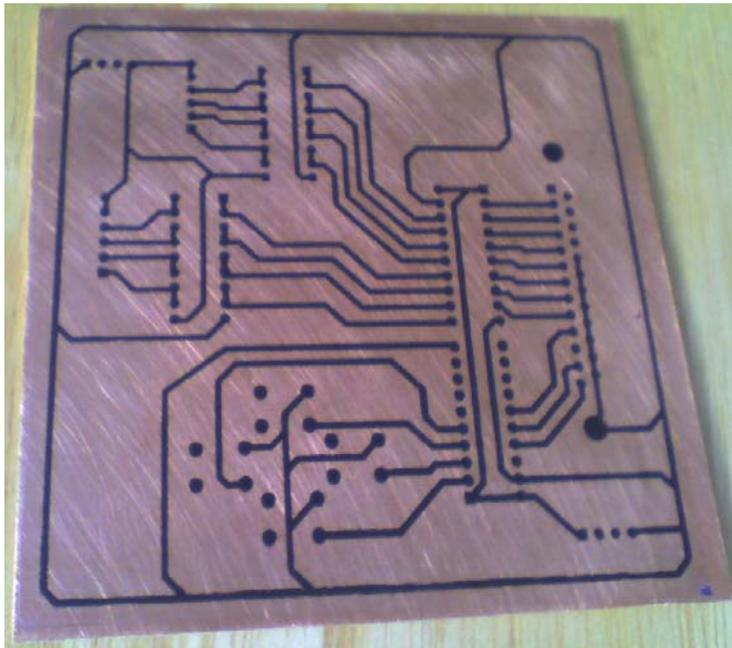
**Figura 3.36.** Impresión sobre la placa de cobre.
