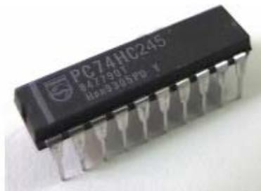
**Figura 3.6.** Aspecto real del circuito integrado 74HC245.
