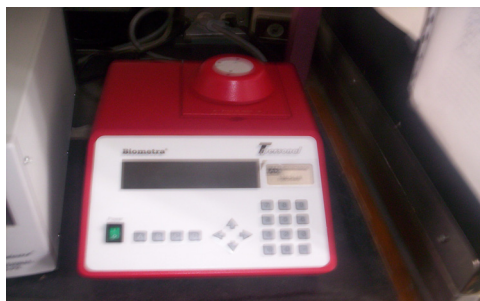
Figura 4.13.1 Termociclador para la PCR
