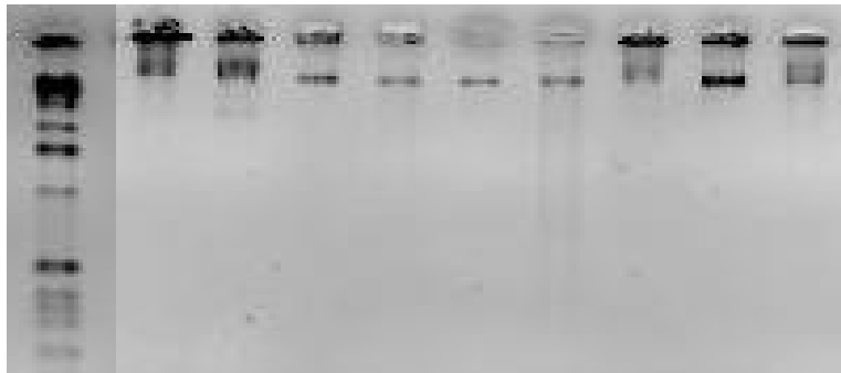
Figura 5.4.1. Gel de agarosa al 1.8 % en el que se muestra el DNA extraído de las primeras 9 cepas de bacterias lácticas. MM = marcador de peso molecular \lambda DNA (100bp DNA Ladder, Gibco BRL). Se cargaron 2 \mu l en cada pocillo de las muestras de DNA de las cepas. Se corrió la electroforesis a 85 v por 35 min.
