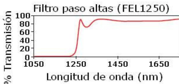
Figura 4.5. Comportamiento del Filtro paso altas.
