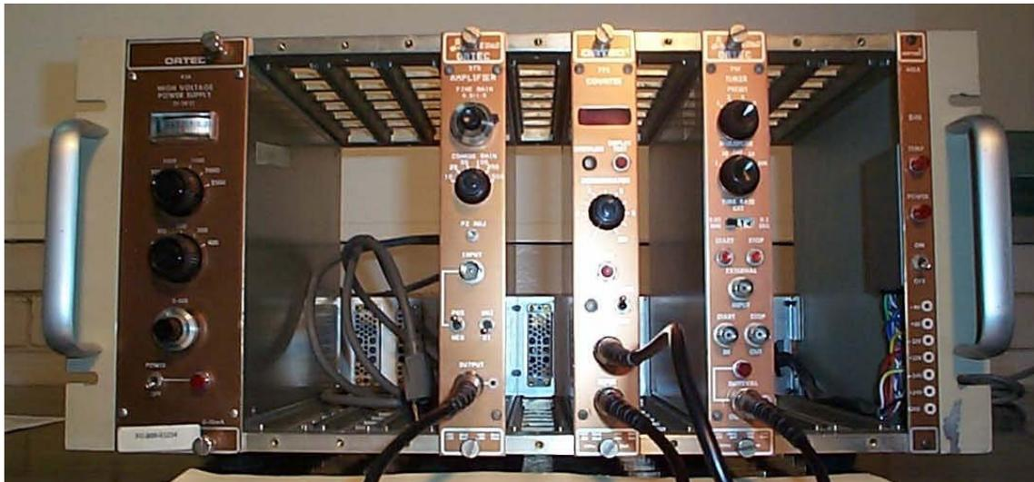
**Figura 4.4. Fotografía de la configuración de un NIM. De izquierda a derecha: a) fuente de alto voltaje, b) amplificador, c) contador, d) medidor de tiempo.**
