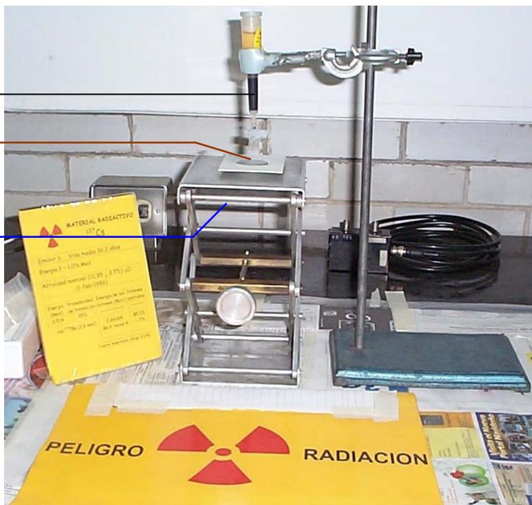
**Figura 3.2:** Sistema para facilitar la obtención de la fuente radiactiva de  $^{137m}\text{Ba}$  en forma líquida.
