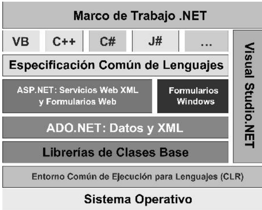
Figura 4.1. Diagrama detallado del Marco de Trabajo .NET
