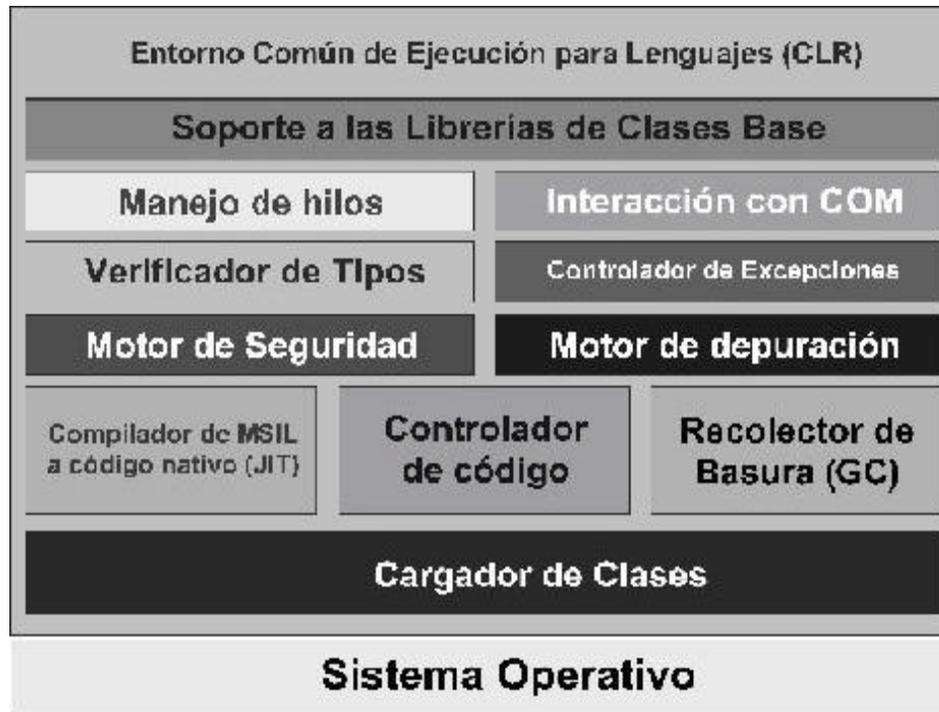
Figura 4.2. Diagrama de la estructura interna del Entorno Común de Ejecución para Lenguajes (CLR por sus siglas en inglés)
