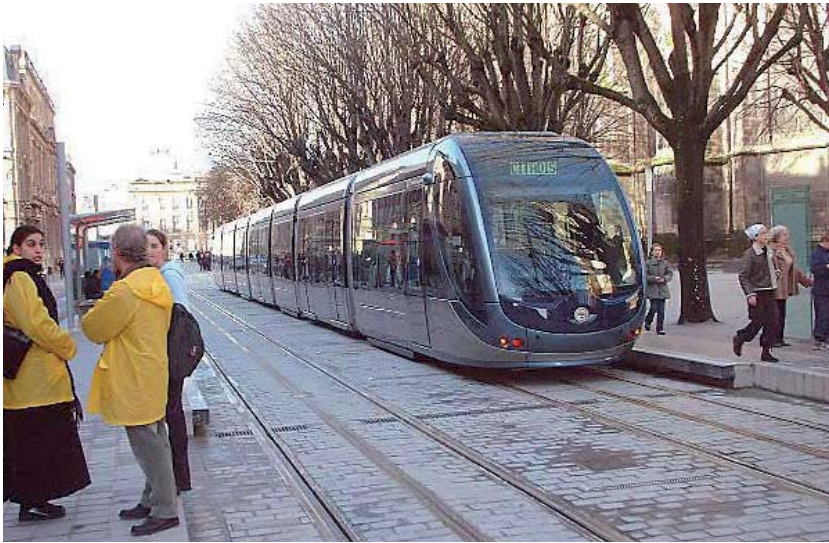
Burdeos, Francia. LRT alimentado por un tercer riel
