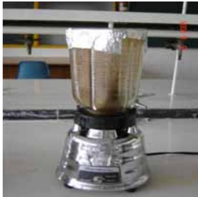
**Fig. No.11 Licuadora casera utilizada como homogenizador**
