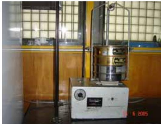
**Fig. No.12 Fotografía del tamizador utilizado en el proyecto**
