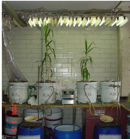
Figura A.11.2 Cuatro reactores que simulan humedales artificiales de flujo vertical a escala de laboratorio (tomada 25 de mayo de 2006)
