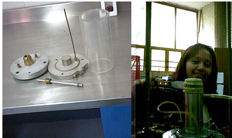
Fotos III.1.4.1 Equipo para la prueba multitriaxial de deformaciones
