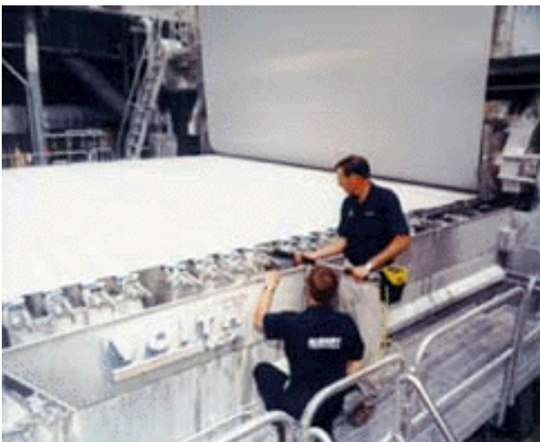
Máquina Fourdrinier fabricando papel bond
