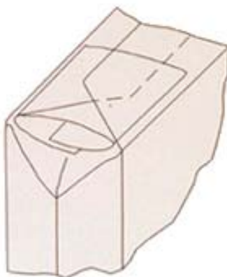
Válvula tubular: Mejor sello que la de tipo inserto, mayor costo
