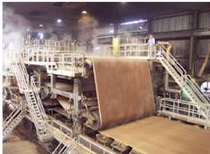
Máquina Fourdrinier fabricando papel kraft.
