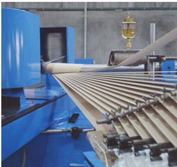
Fabricación de tubos en espiral
