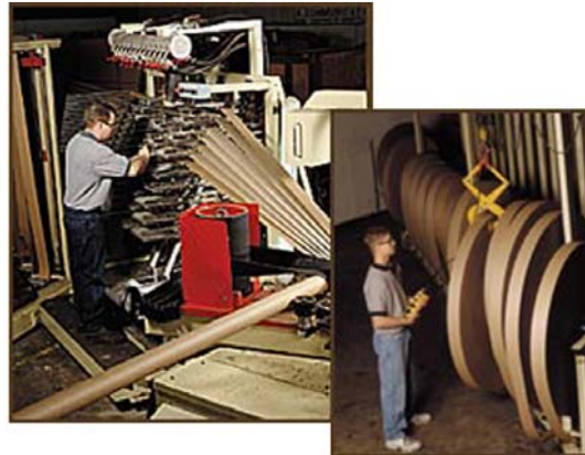
Máquina cortadora de papel kraft , su principal función es la de cortar una bobina de papel en varias secciones, con el fin de conseguir el ancho requeridos para la fabricación de tubos ya sea en espiral o en paralelo.
