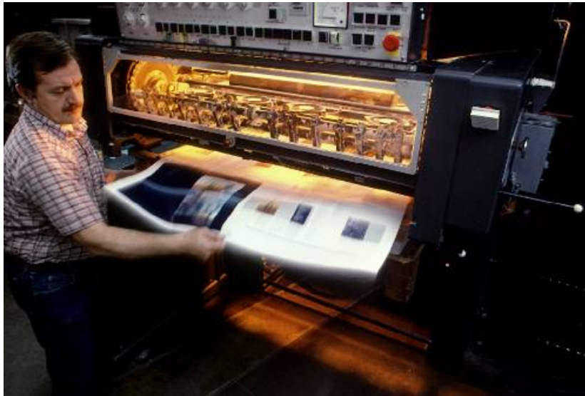
El offset es el sistema más utilizado por los impresores por la combinación de buena calidad y economía en comparación con otros sistemas, así como en la versatilidad de sustratos. Fuente: www.packagingdigest.com
