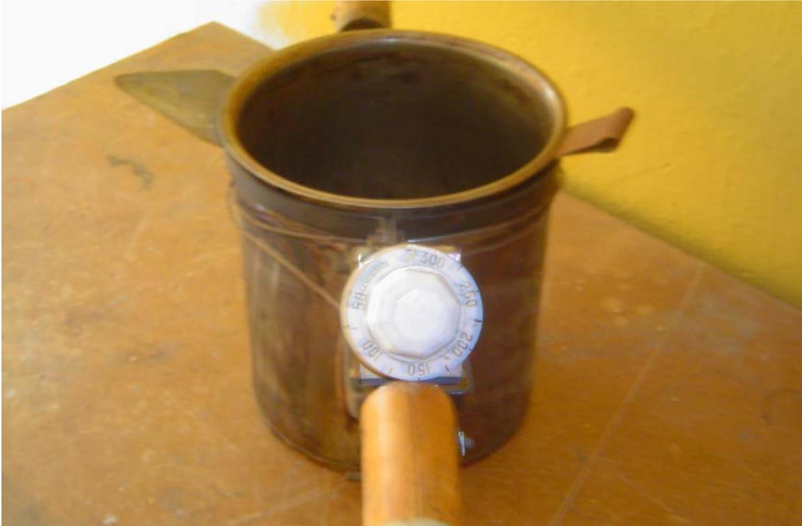
foto 2.1. Recipiente de fundición fabricado en los talleres de la Facultad de Ingeniería.
