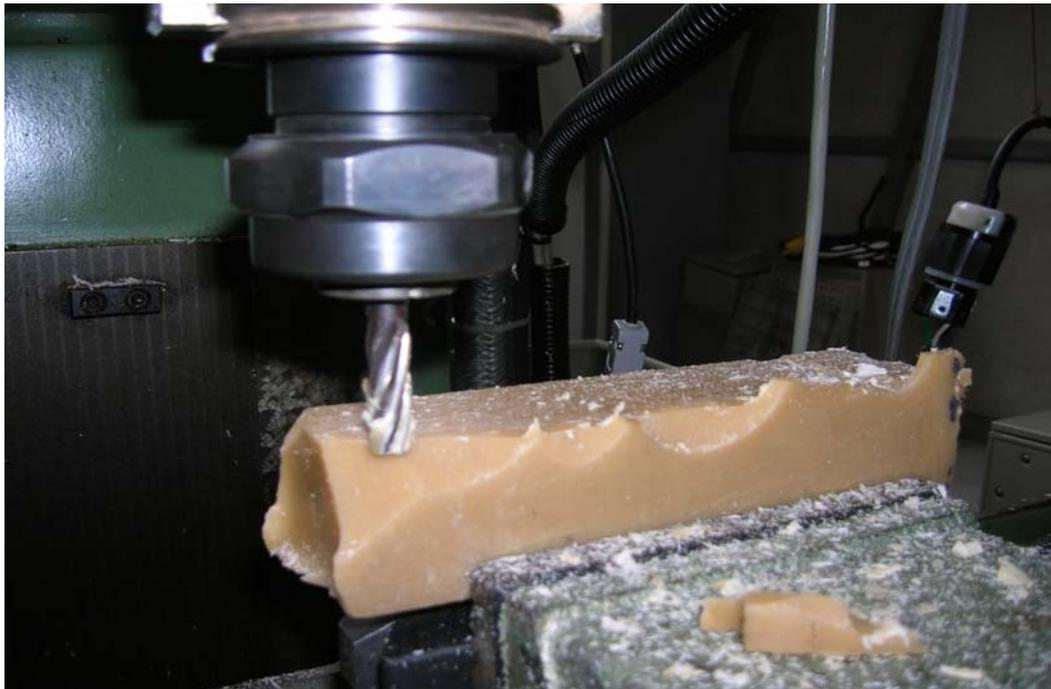
foto 3.9.A 2400rpm y 1cm/s de avance, las ceras se fracturaron
