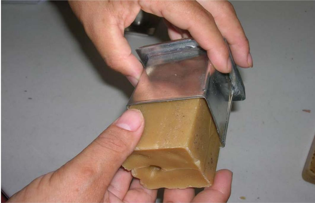
foto 2.18 El material frío se contrae y sale con solo voltear el molde
