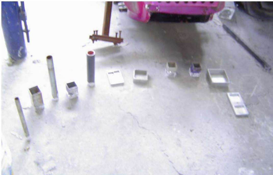
foto 2.5 Diferentes moldes utilizados en el proceso de moldeo
