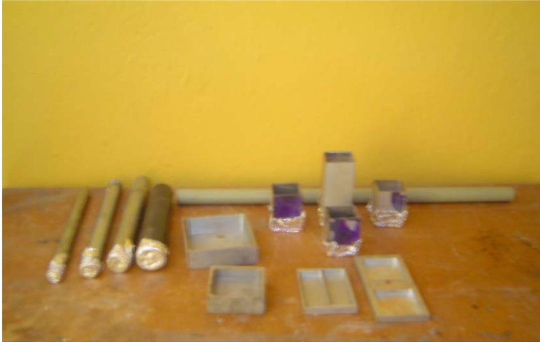
foto2.4 Diferentes moldes utilizados en el proceso de moldeo
