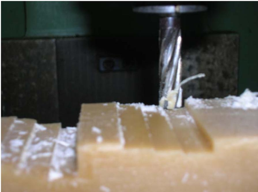
foto 3.4 primeras pruebas se hicieron a una velocidad de 900rpm
