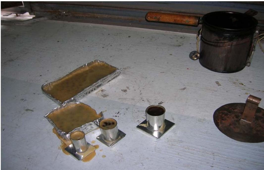
foto 2.14 El tiempo de enfriado depende del volumen de la pieza .
