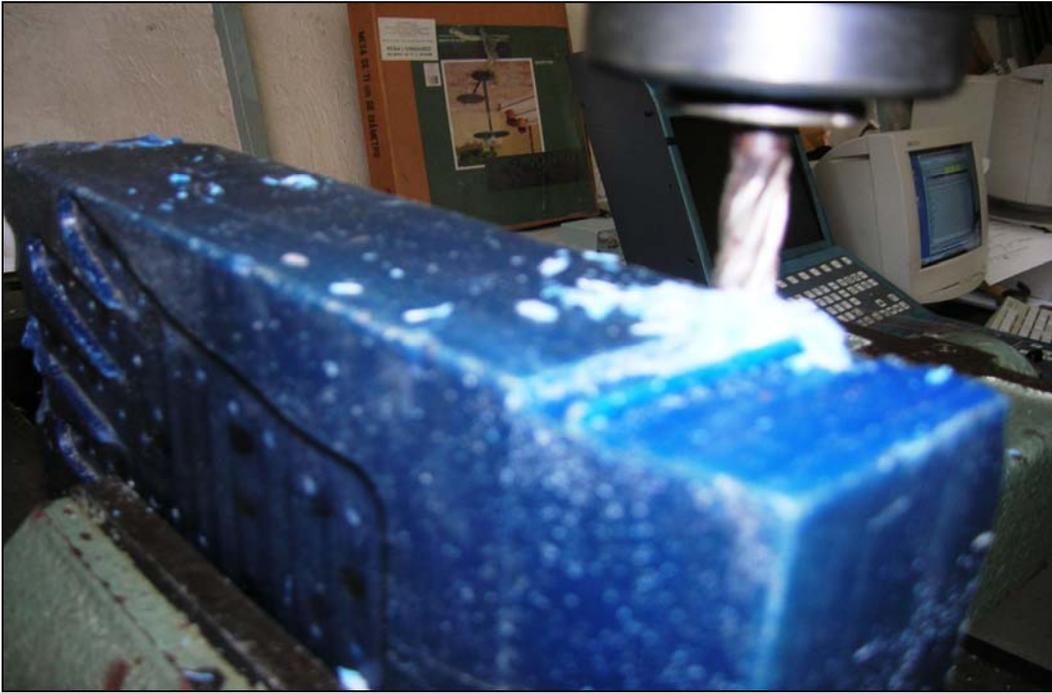
foto 3.5 primeras pruebas se hicieron a una velocidad de 900rpm
