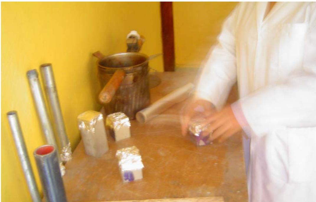
foto 2.3 Habilitación de moldes para ser utilizados en el moldeo.
