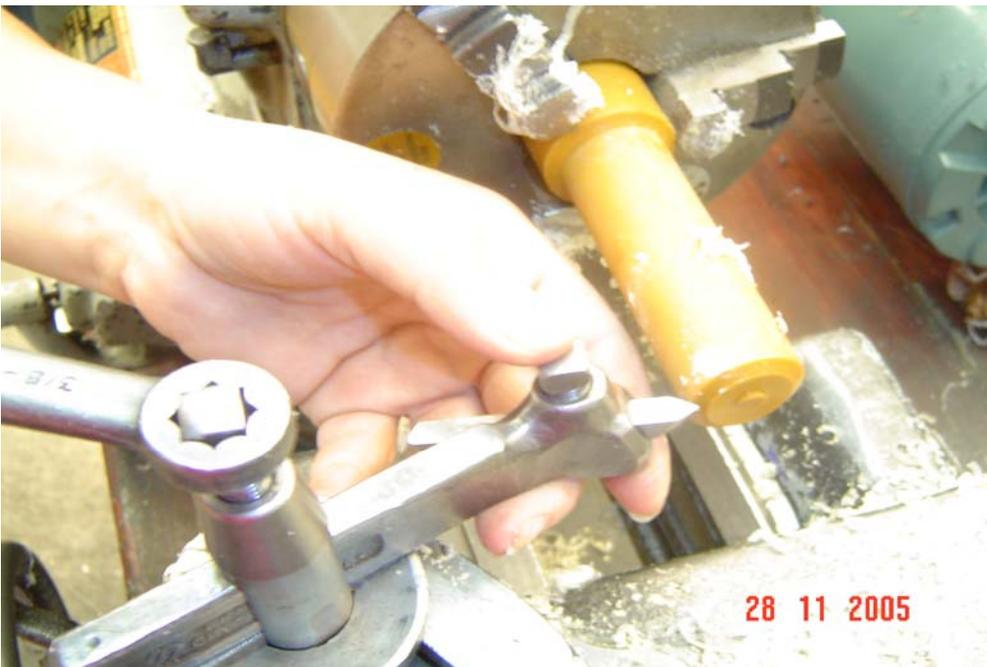
Foto 3.3 Acabado del P.C.P. en el caso de herramientas desafiladas.
