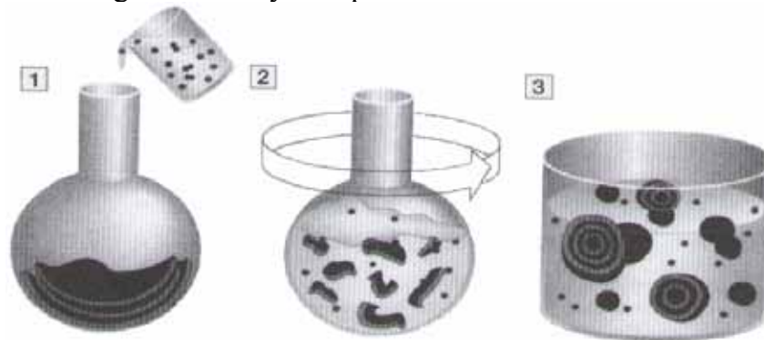
Figura 26: Representación de la elaboración de una suspensión de nanoesferas. 1. hidratación de la cama lipídica con la solución elegida, 2. agitación mecánica y 3. formación de las vesículas.
