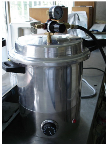
Fig. No. 6 olla de presión con control de temperatura y presión
