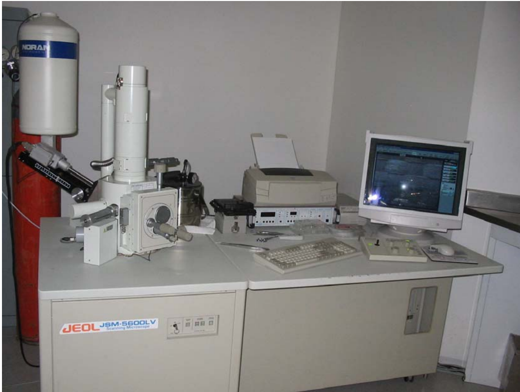
Figura 18. Se utilizó un microscopio electrónico de barrido de bajo vacío marca JEOL JSM-5600LV. Foto proporcionada por el Dr. Jesús Arenas, Instituto de Física, UNAM
