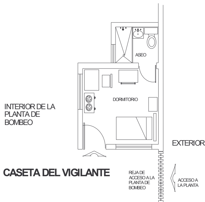
Fig. 3.2 Caseta del vigilante en una planta de bombeo
