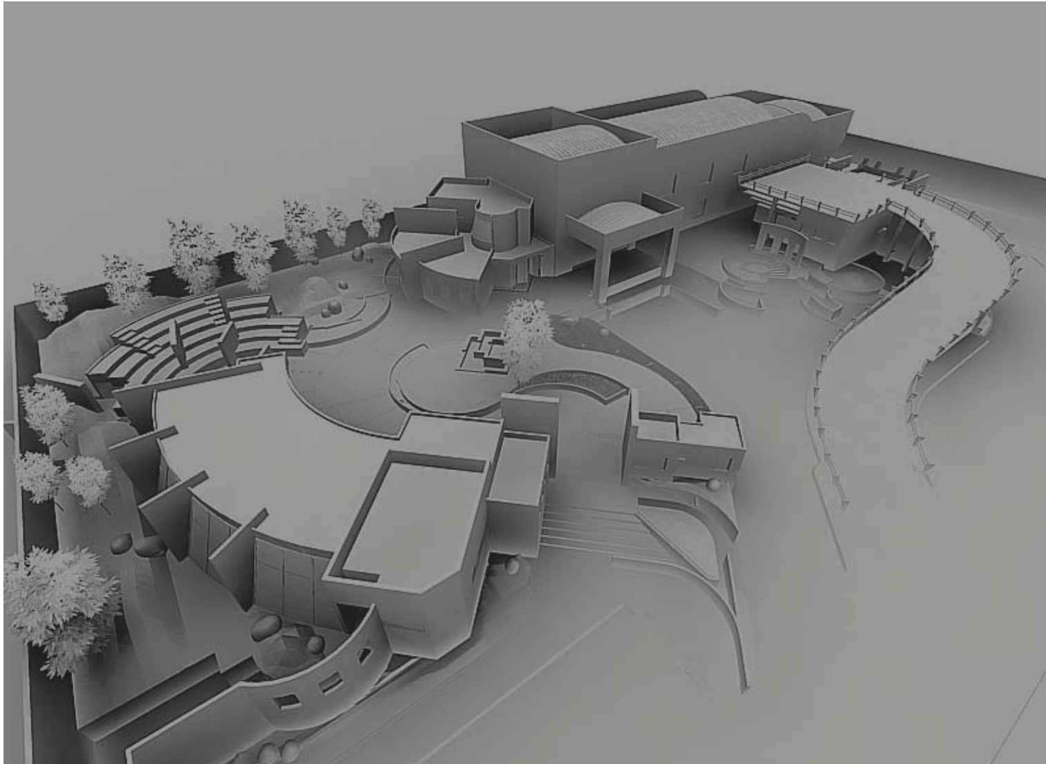
Vista isométrica del conjunto. La identidad orgánica del diseño prevalece sobre la longitudinalidad de la nave de separación, que además se rompe por la presencia de tres volúmenes: un receptáculo en la cola de la nave; la nave misma, que es un solo cuerpo longitudinal suavizado en una de sus esquinas superiores y, finalmente, un cubo porticado para la salida del producto final recuperado.
