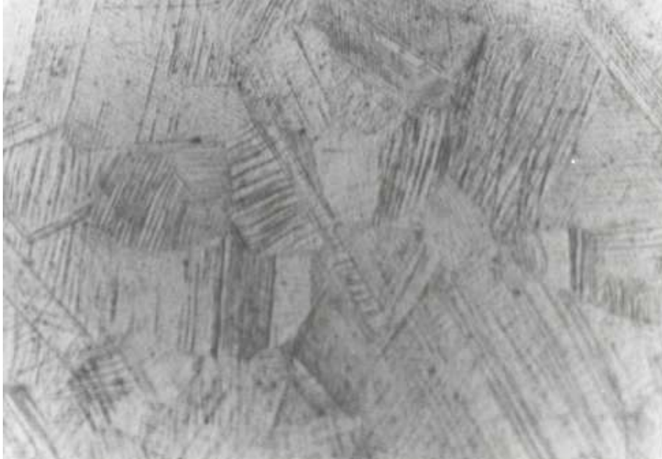
Figura 1.5 Microestructura del acero 316L (Marble's, 30 seg.; 500x)
