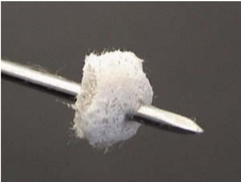
Figura 5. PGLA después de 3 inmersiones en PLA.
