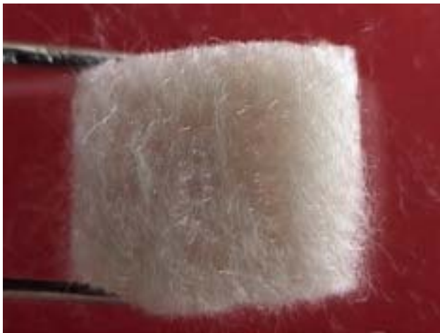
Figura 3. Disco de PGA de 8 x 0.5 mm las fibras son de 15 \mu m de diámetro con una distancia interfibrilar de 100 a 200 \mu m (Albany International, Albany, NY).
