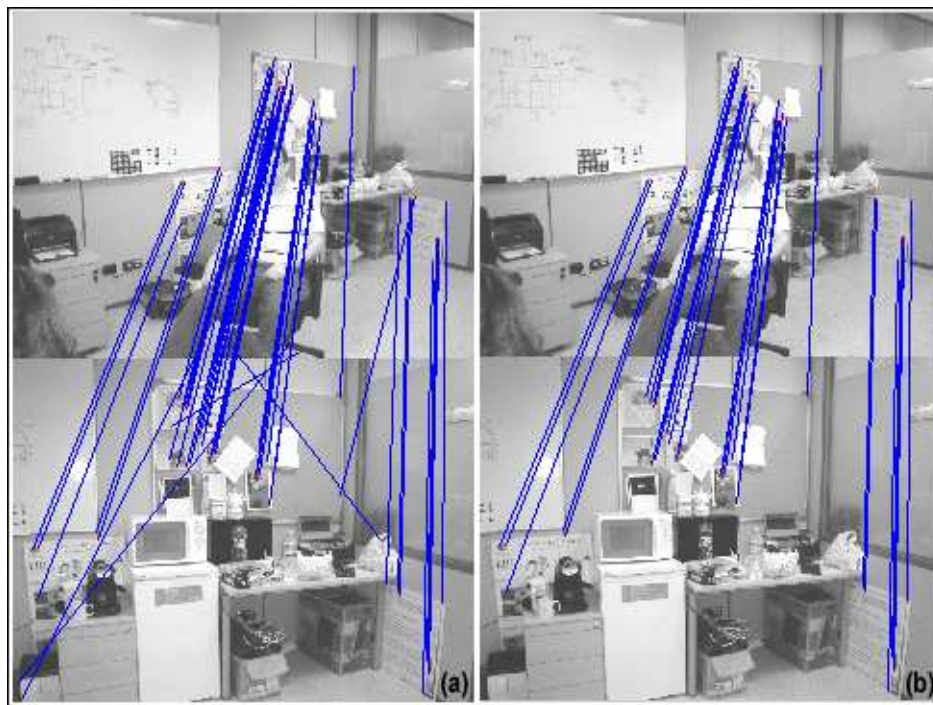
Figura 4.20: Emparejamiento inicial obtenido con el algoritmo BBF (a) y final obtenido con el algoritmo de Transformación de grafos (b) de la escena laboratorio1 bajo el efecto de oclusión parcial.
