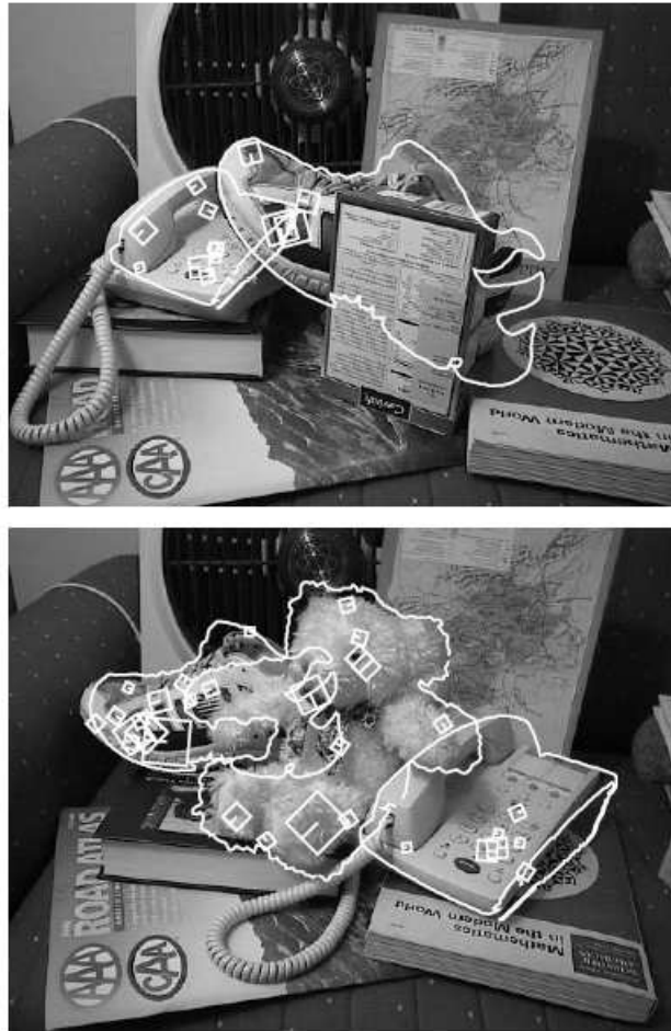
Figura 1.2: Ejemplo del reconocimiento de los objetos con oclusiones, usando SIFT. Imagen tomada de [50].
