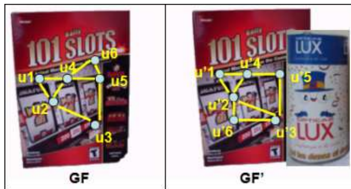
Figura 3.3: Ejemplo de los grafos de un emparejamiento inicial entre las características de la imagen del modelo (izquierda) y las de la escena (derecha), con k = 2 .
