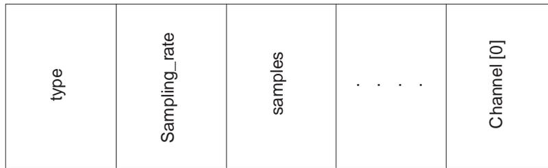
Figura 3.5: Estructura WAVE\_DATA.
