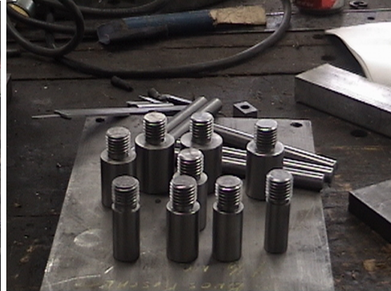
b) Pernos que darán el diámetro interno del anillo plástico
