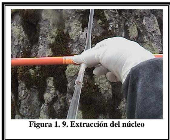
**Figura 1. 9. Extracción del núcleo**
