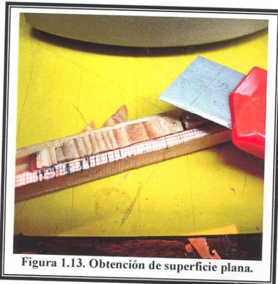
Figura 1.13. Obtención de superficie plana.
