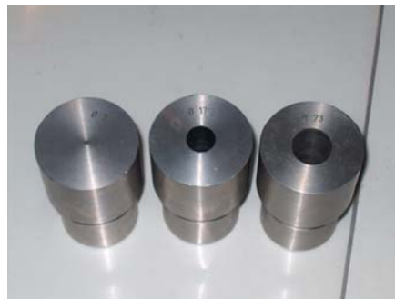
Figura 6. a). Colimadores circulares (2,17,23 mm) b). colimador multihojas Leibinger
