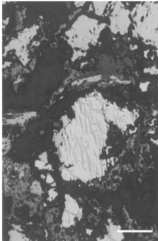
Figura 62. Siegenita (mineral más blanco) parcialmente reemplazada por calcopirita. Sección pulida. Luz reflejada. La escala representa 0.2 mm.
