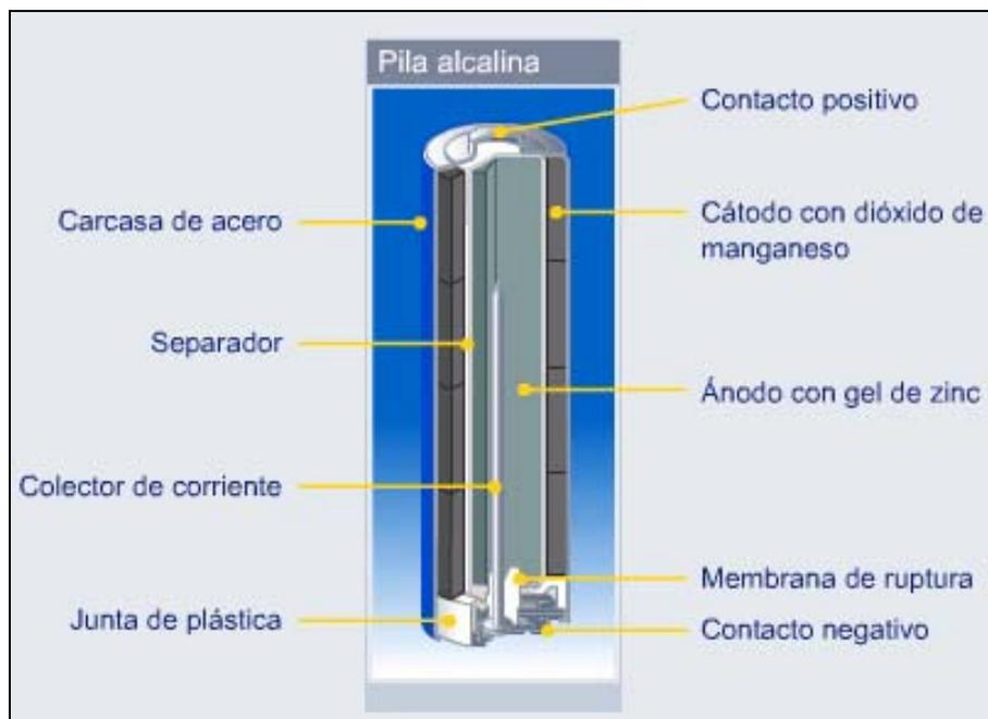
**Figura 1.4.** Componentes de una pila alcalina.
