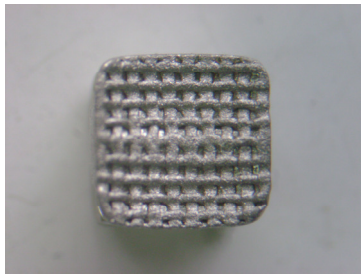
Fig. 14. Se observa a la mitad de un bracket nuevo (Morelli), el ejemplo de una malla irregular por la electro soldadura.
