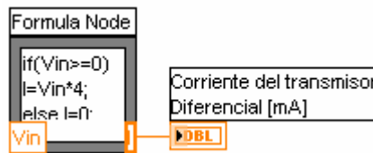
Figura 4.11 Bloques utilizados para conocer la corriente a través del Transmisor de Presión Diferencial
