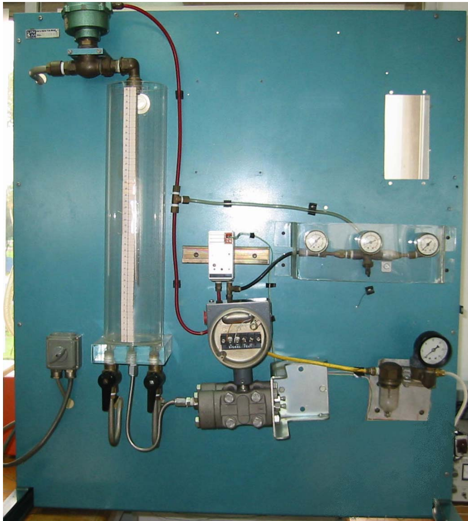
Figura C.1 Planta de Nivel antes de ser restaurada
