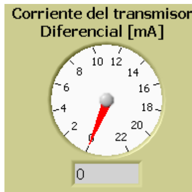
Figura 5.5 Indicador de la Corriente a través del Transmisor de Presión Diferencial
