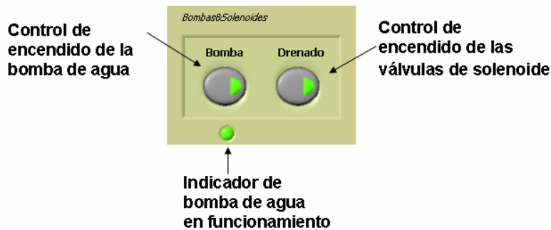
Figura 5.3 Controles On/Off de la bomba de agua y válvula de solenoide
