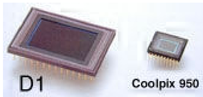
Figura 2.6 Sensor de la cámara Nikon D1 comparado con el de la coolpix 950, una cámara no profesional de buena resolución (Hernández, 2003)
