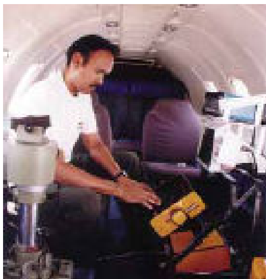
Figura 1.7 Equipo a bordo de aeronaves, para la adquisición de imágenes aéreas digitales (Laboratorio de SIG Y PR, Instituto de Geografía, UNAM)
