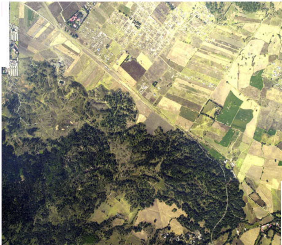
Figura 2.1 Imágenes estereoscópicas que se traslapan un 60%, lo que permite la visión tridimensional del terreno (Laboratorio de SIG Y PR, Instituto de Geografía, UNAM)
