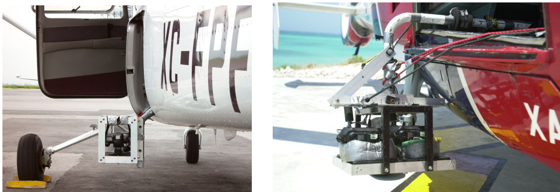
Figura 1.10 Montaje de las cámaras en la parte exterior de las aeronaves (Laboratorio de SIG Y PR, Instituto de Geografía, UNAM)
