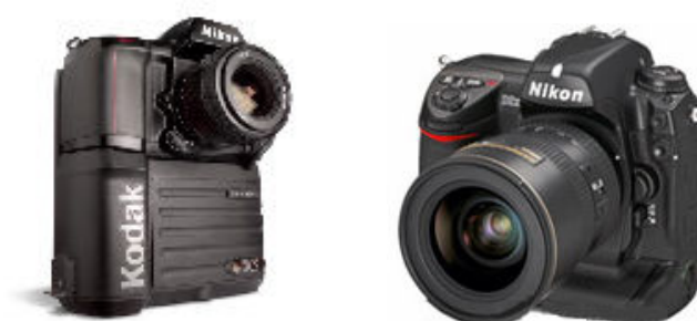
Figura 2.2 Algunos ejemplos de cámaras fotográficas de pequeño formato (35 mm), utilizadas para obtención de fotografía aérea digital (Laboratorio de SIG y PR, Instituto de Geografía, UNAM)
