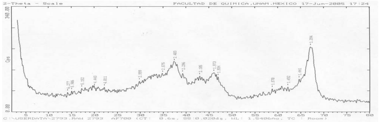
Gráfica 4.3. Análisis DRX a alúmina fluorada 4%N calcinada a 700° C
