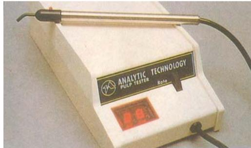
**Fig. 26** Comprobador pulpar eléctrico.
