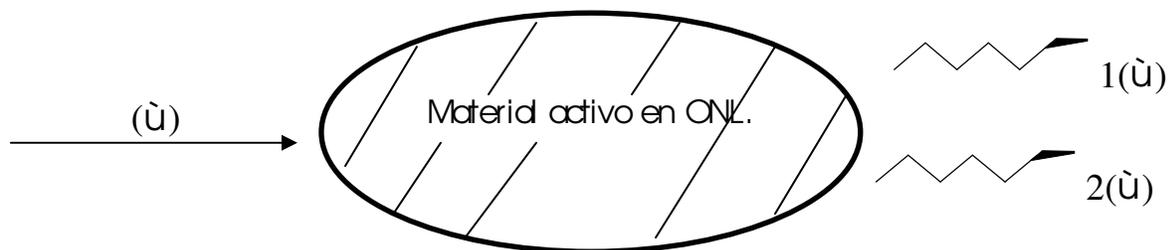
*Esquema 7.* Generación del segundo armónico.
