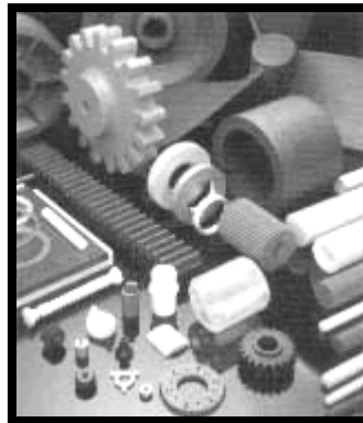
Figura 3.3 Materiales no metálicos
