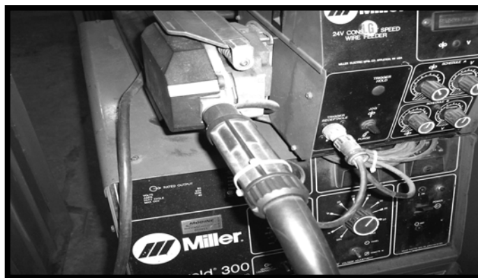
Figura 6.6 Sistema de control y alimentador del paso del alambre al gatillo
