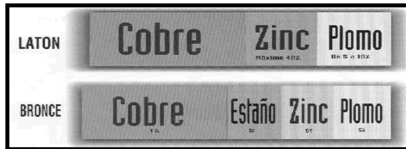
Figura 2.4 Composición química del latón y bronce
