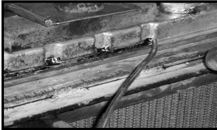
Figura 5.4 Proceso en el cual por medio de la soldadura de estaño (como material de aporte), se une las dos piezas de latón.
