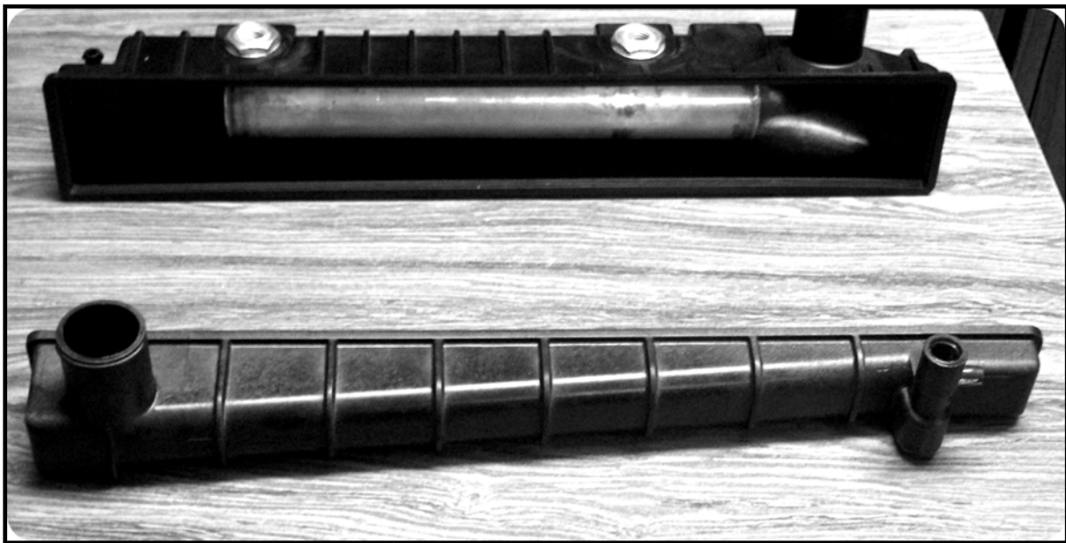
**Figura 8.6 Tanques obtenidos de la inyección del plástico
