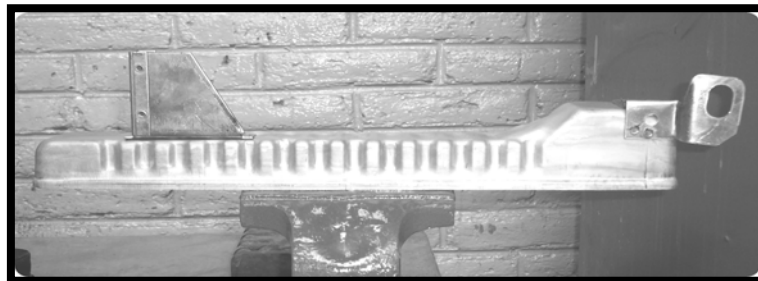
Figura 7.7 Muestra terminada después de la aplicación del proceso de soldadura de resistencia por puntos
