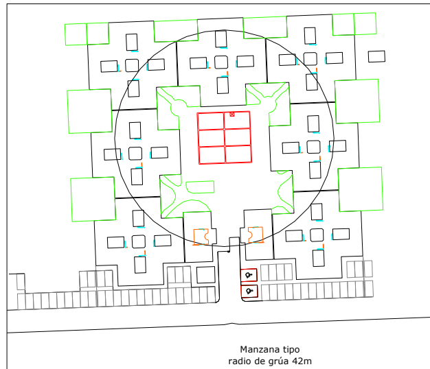
Fig. VI.10 Giro de grúa torre
