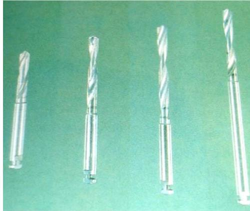
Fig. 36 Drills de 2 mm de diámetro
