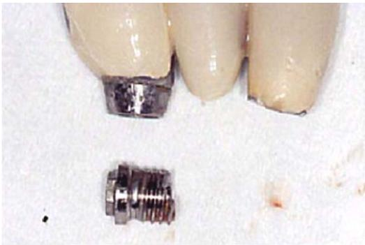
Fig. 27 Fractura por fatiga
