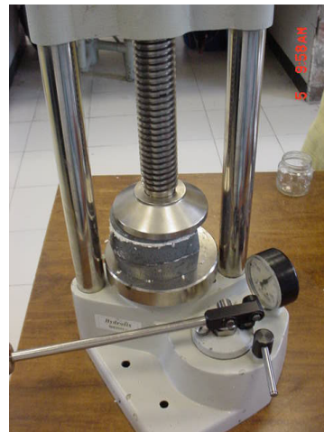
Colocación de la mufla en la brida
