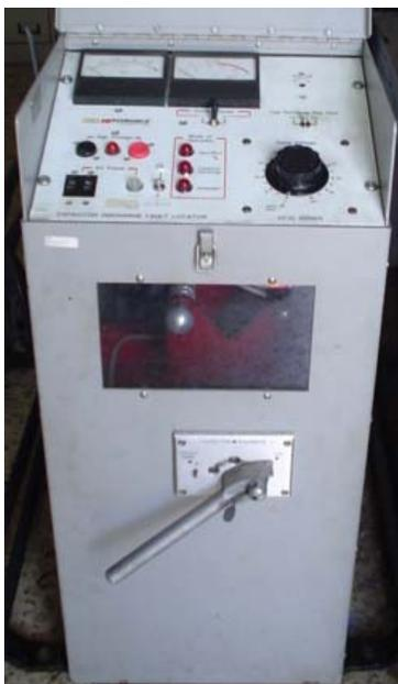
*La fotografía 6.2 Muestra el generador de impulsos o localizador de fallas.*
