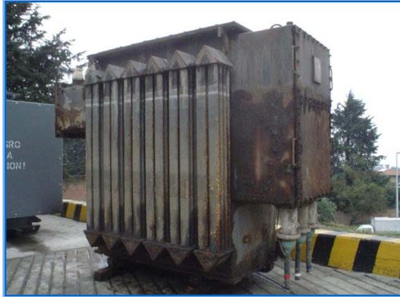
*La fotografía 4.1 Muestra equipo dañado, transformador sumergible de 6kV con fuerte oxidación.*
