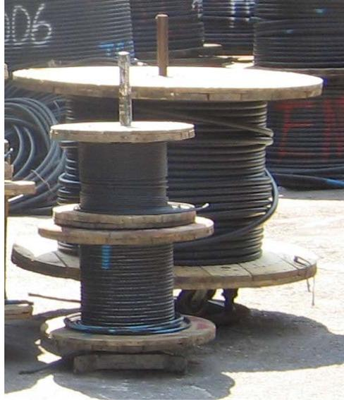
*La fotografía 5.16 Muestra Cable BTC Calibre 15; 35; 70 y 150 mm<sup>2</sup>.*
