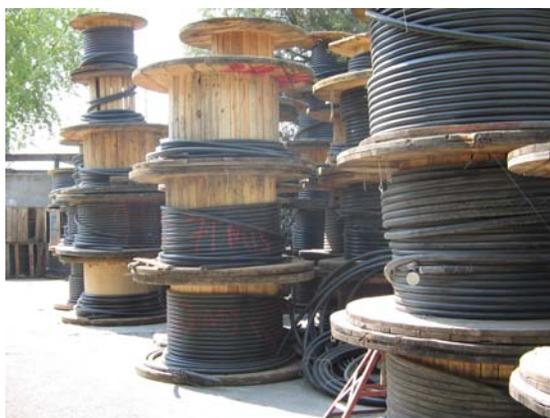
La fotografía 5.1 Muestra bobinas de cable para mediana tensión 23TC.
