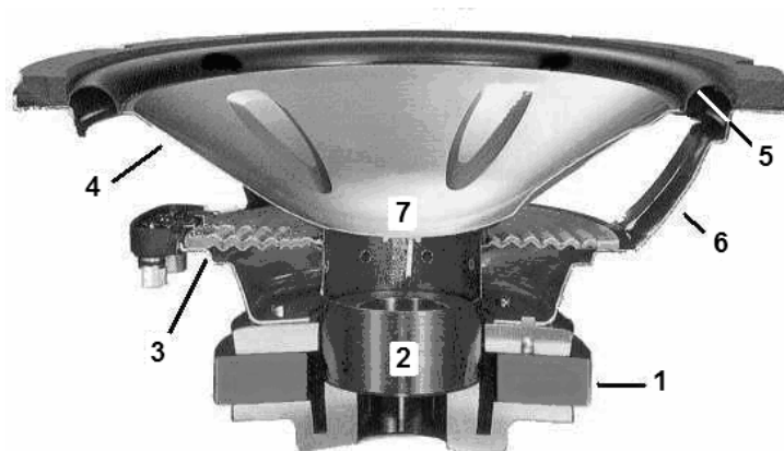
Figura 3.2.- Partes que conforman un altavoz electrodinámico: 1)Imán permanente, 2)Bobina móvil, 3)Suspensión interior (araña), 4)Diafragma, 5)Suspensión exterior, 6)Estructura Metálica, 7)Guardapolvo
