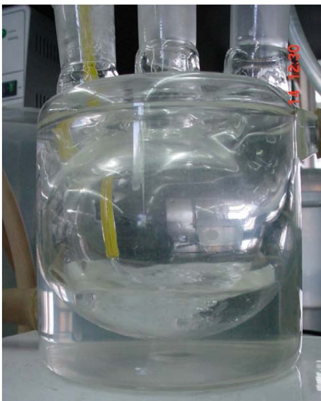
Figura 3-8 Mezcla reactiva con acetonitrilo calentándose a 60°C
