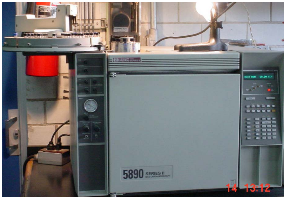
Figura 3-11 Cromatógrafo de gases empleado en el análisis de las muestras de reacción
