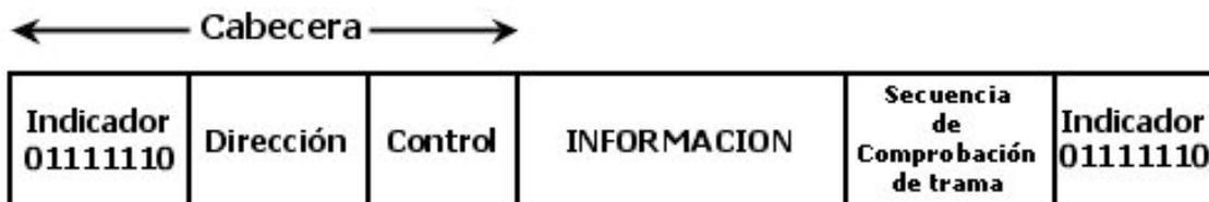
*Figura 6.14 Formato de una trama de HDLC con sus delimitadores*
