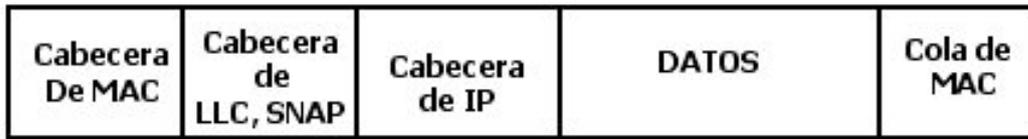
Figura 6.23 Formato de transmisión de una trama de LAN
