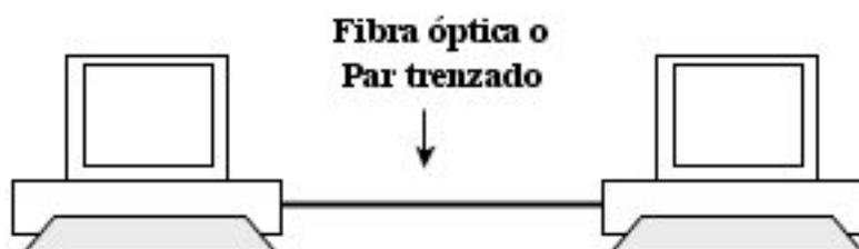
Figura 5.9 Conexión Punto a Punto.
